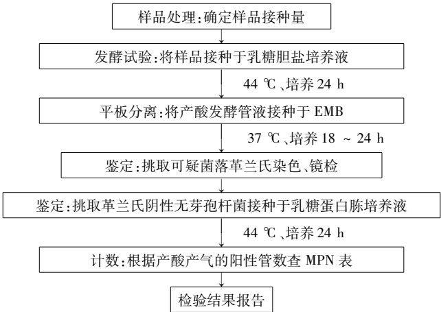
图 A1 污水、污泥中粪大肠菌群检验程序
